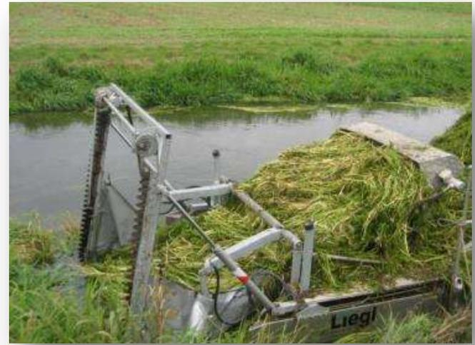
Um die **Nutzbarkeit von Seen** und **den Hochwasserschutz bei Fließgewässern** zu gewährleisten, werden regelmäßig **Entkrautungen** durchgeführt.
