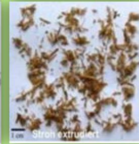
Bioextruder® der Firma LEHMANN und aufbereitete Strohproben
